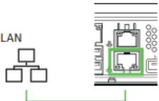
Nach der Konfiguration erfolgt ein Neustart des Retail Data Storage. Verbinden Sie danach den LAN Port 2 mit Ihrem Werkstattnetzwerk für den produktiven Einsatz.
