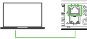
Verbinden Sie das Konfigurationsgerät mit dem LAN Port 1 (entfernen Sie vorübergehend die rote Staubschutzabdeckung).
